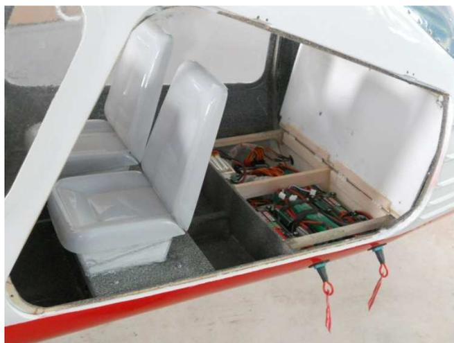
Position de l'installation radio : sous un siège.
