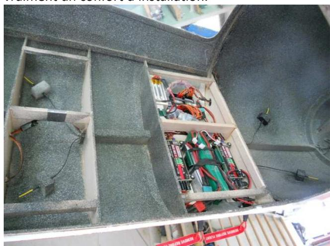
La position des antennes qui est retenue : elles sont posées en fond de plancher éloignées des équipements électriques
