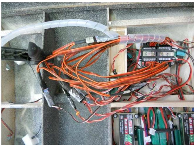
Voilà le travail, cela fait bien du monde à placer et sécuriser les connecteurs + isoler les Fiches en attentes sur les ENLINK, Un boîtier regroupant 5 Enlink serait vraiment un confort d'installation.
