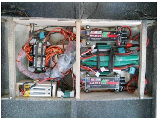
Quand tout est en place, on voit plus clair. Deux régulateurs + 4 accus lipo + 2 récepteurs + 8 ENLINK + contacteur et accus pour fonctions auxiliaires
